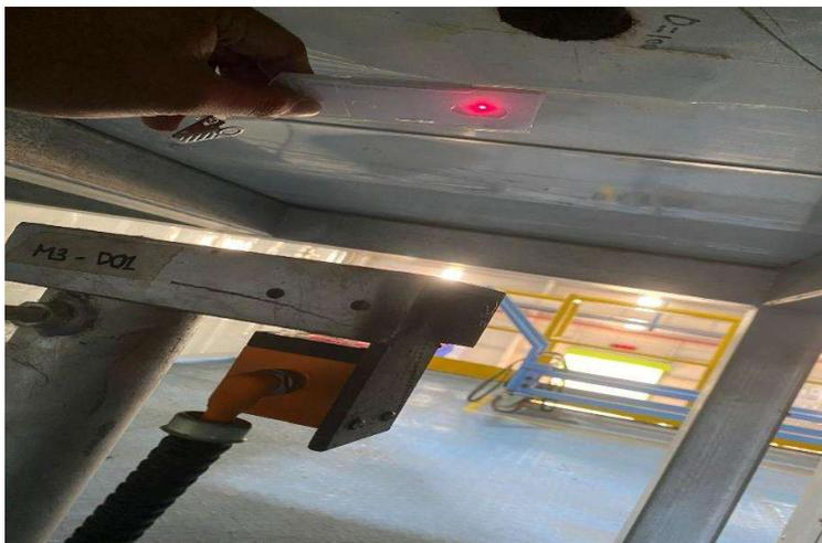
7. Hasil HMI after pemasangan sensor laser yang baru
