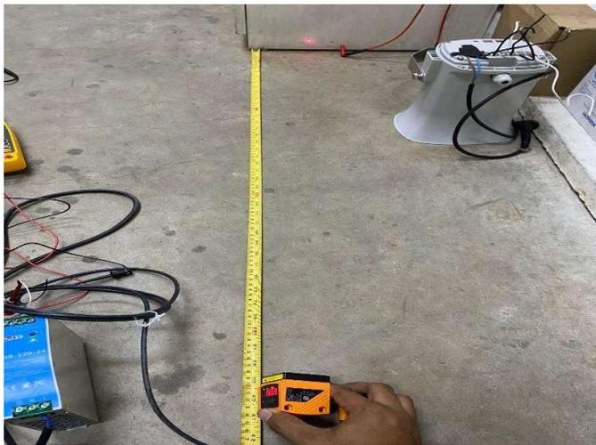
3. Melakukan pengukuran menggunakan meteran sesuai dengan panjang standar yang akan dipasang dan melakukan perbandingan dengan sensor laser 2
